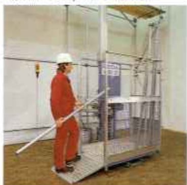
Зубчато-реечные подъемники с алюминиевой мантой
