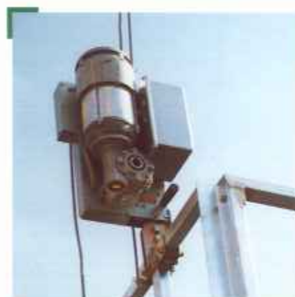
Die Antriebe können auch an den Stirnwänden aufgehängt werden, die mit speziellen Befestigungspunkten versehen sind. Dies ist eine kostengünstige Alternative.
