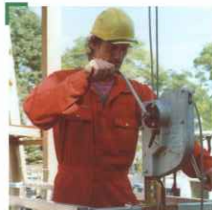
Speziell in explosionsgefährdeten Umgebungen hat sich der Handantrieb bewährt.
