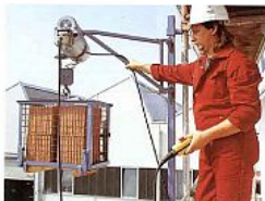
A GEDA lengőkáros emelőcsőrökkel minden teherbírási kétszerese, végig 150 kg-ra növelhető, ha csigortartó használt.
