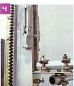
A szállítókocsi elektromos motoros hajtóművese a finom szabályozást teszi lehetővé, és megkönyíti az alumíniumprofilokat.
