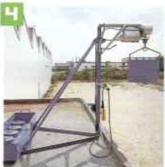
Der freistehende Dreibein mit Ballastbehälter für Flachdach und offene Etagen ist zerlegbar zum einfachen Transport.
