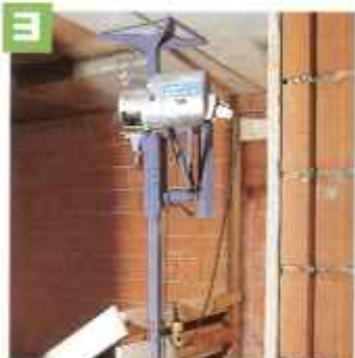
Die Geschosstütze ist ausziehbar von 230 - 325 cm, bietet durch einen zusätzlichen anreihbaren Schwenkarm eine sehr große Ausladung bis zu 155 cm und kann durch die zwei Gelenke bereits bei sehr schmalen Fenstern ab ca. 70 cm eingesetzt werden. Zusätzlich ist die Auslegerhöhe verstellbar.
