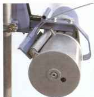
Der Motor stoppt bei Schlaffseilbildung – das Seil bleibt straff auf der Trommel!
