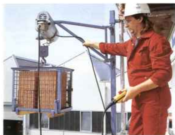
Mit GEDA® -Schwenkarmzügen kann am Bau viel Zeit und Kraft gespart werden. Kugelgelagerte Haken und Hakenflasche verhindern als Drallfänger das Aufdrehen des Seiles.
