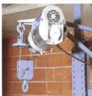
Mit der kugelgelagerten Hakenflasche wird die Tragkraft des GEDA-MINI 75/150 auf 150 kg verdoppelt.
