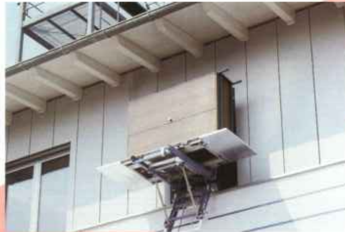
Die verfahrbare Drehbühne bleibt – durch Endschalter gesteuert – direkt vor dem Fenster stehen
